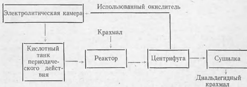
Рис. 46. Технологическая схема процесса получения диальдегидного крахмала.
